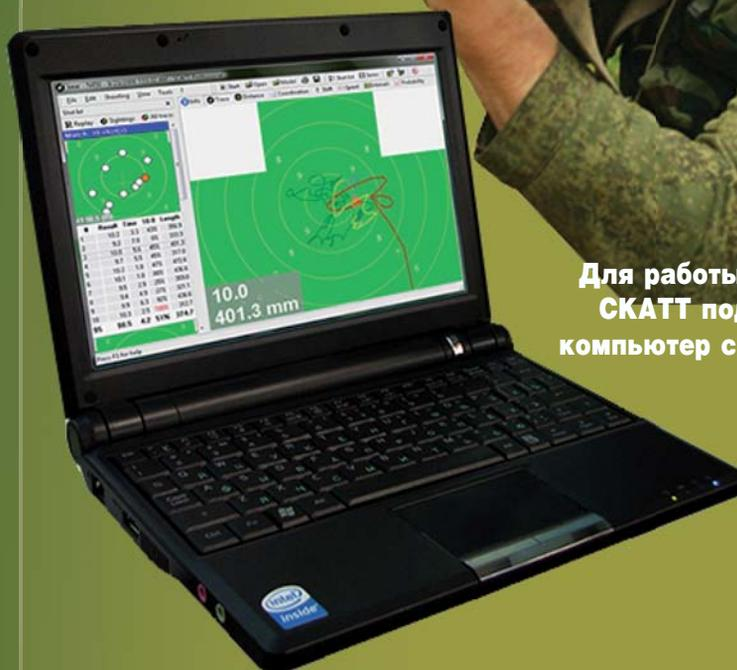
СКАТТ WS1 — это электронный компьютерный тренажер, комплектуемый **беспроводным** оптическим датчиком и предназначенный для тренировок и стрельбы по неподвижным мишеням из пистолета, винтовки, автоматического оружия. Тренажер может эксплуатироваться в закрытых помещениях с дистанцией от 4 до 10 метров, имитируемая дистанция до 1000 метров.
