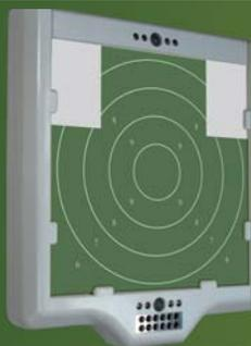
СКАТТ WM9 — это электронный компьютерный тренажер, комплектуемый **беспроводным** оптическим датчиком и предназначенный для использования с пистолетами (макетами пистолетов) калибра 9 мм. Тренажер может эксплуатироваться в закрытых помещениях с дистанцией от 4 до 6 метров, имитируемая дистанция стрельбы до 300 метров.
